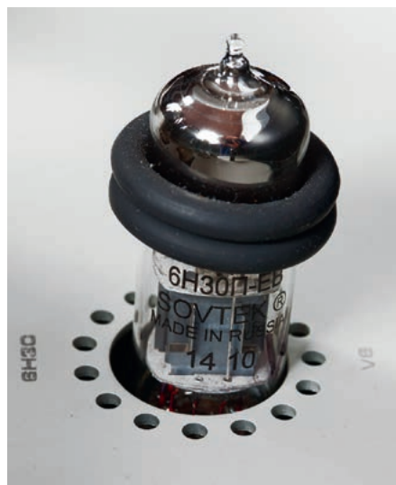
Triody 6H30 w stopniu napięciowym wybiera obecnie wielu producentów – są znane z klarowności brzmienia.
