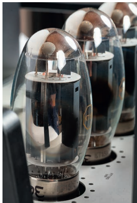
Lampy KT150, przy stosunkowo prostym układzie i zaledwie jednej parze (na kanał) pozwalają uzyskać wysoką moc i niski poziom zniekształceń.
