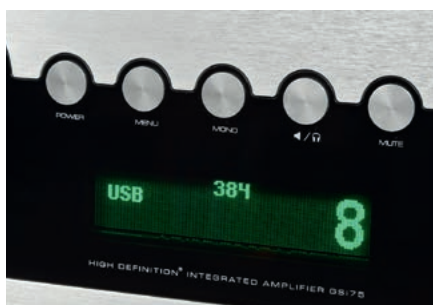
Matryca wyświetlacza, oprócz wskazania poziomu głośności i wybranego wejścia, ułatwia poruszanie się po (skromnym) menu.
