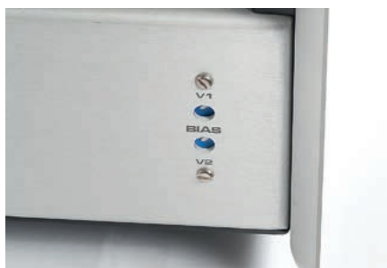
Za kalibrację lamp (obowiązkową przy ich wymianie) odpowiadają cztery (po dwa na stronę) regulatory.
