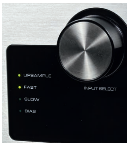
W czytelnej formie prezentowana jest konfiguracja sekcji cyfrowej, ważny jest tutaj wybór rodzaju filtra oraz ewentualna aktywacja układu upsamplera.
