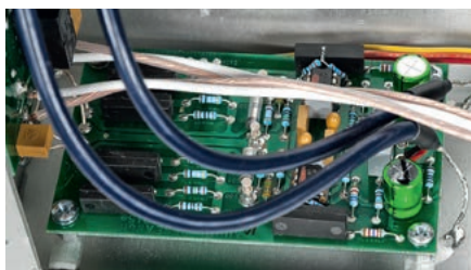
Układ przedwzmacniacza gramofonowego, który zwłaszcza w przypadku ustawienia dla wkładek MC musi mieć bardzo wysokie wzmocnienie (zwykle ok. 60 dB, w GSi75 jest to 62 dB), wykonano na oddzielnej płytce drukowanej z użyciem scalonych wzmacniaczy operacyjnych.
