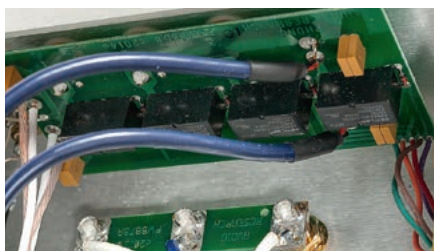
Moduł wejść analogowych sprowadza się do przełączników odpowiedzialnych za ich wybór; do niewielkiej płytki podłączono również mieszczący się tuż obok przedwzmacniacz phono.
